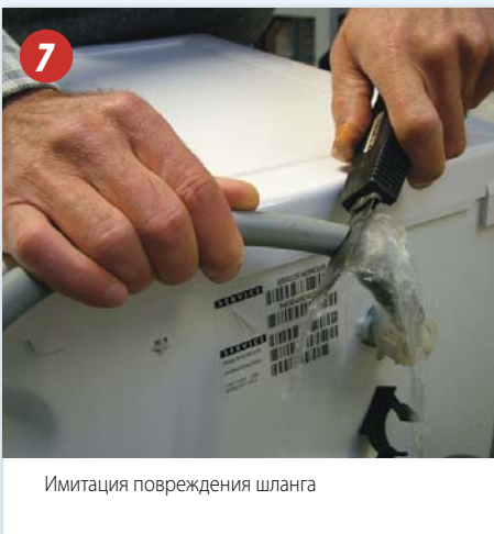
Имитация срыва шланга (возможен, например, в случае некачественного обжима шланга или при гидроударе)
